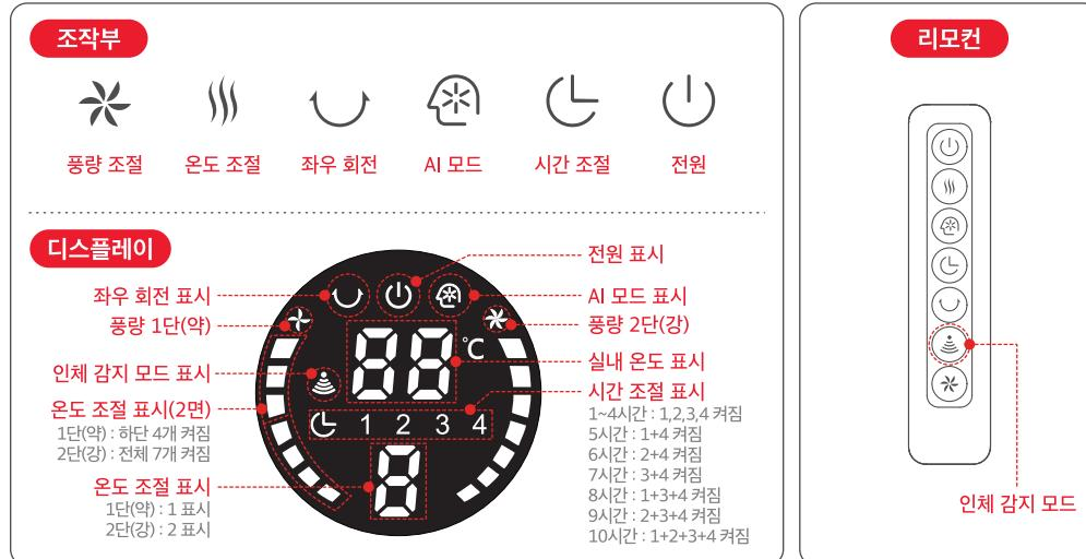
전원 플러그를 끊고 제품 후면의 주전원 스위치를 누르면 모든 버튼의 표시등이 켜졌다 꺼지고 대기 상태가 됩니다. 전원 버튼을 누르면 1단(약)으로 작동합니다. 한 번 더 누르면 작동이 종료됩니다. 기기 12시간 연속 작동 시 안전을 위해 자동으로 전원이 종료됩니다. ※ 주전원 스위치를 켜지 않으면 기기가 작동하지 않습니다. 히터는 반드시 평평한 바닥에서 사용하십시오.
