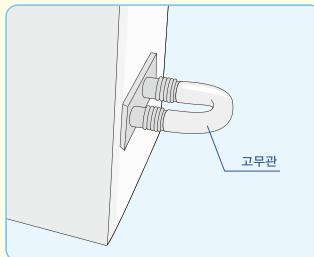
1. 초기 설치된 고무관은 포장 후 누수를 막기 위한 것이므로 고무관을 빼고 제품을 설치하세요. 고무관은 추후 물품보관시 사용하세요.
