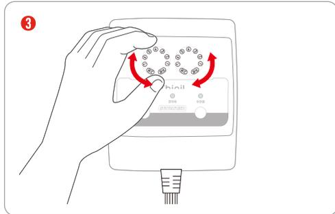
온도 조절 다이얼을 돌려 처음에는 고온으로 설정 후 따뜻해지면 원하는 온도로 설정하십시오. 설정한 온도는 조절 표시창에 표시됩니다. 또한 온열이 되고 있는 동안의 온도 상태를 알려 줍니다. 온열 표시등에 불이 켜져 있을때 온열이 되고 있는 상태입니다.
