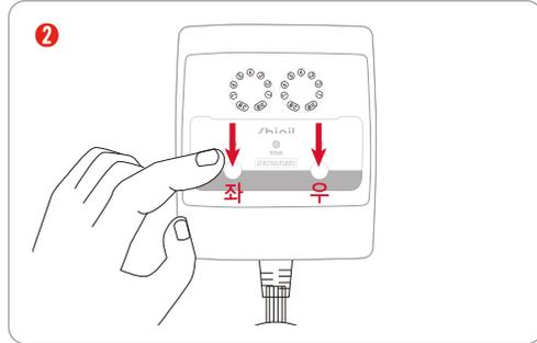
전원 버튼은 좌측과 우측에 각각 하나씩 있으며, 각 버튼은 분리형 난방 제품의 좌측과 우측의 전원을 따로 설정할 수 있습니다. 조절기의 전원 버튼을 누른 후 원하는 온도로 조절기를 돌려 사용하십시오. ※ 사용자의 안전과 전력 소모를 줄이기 위해 전원이 켜진 후 15시간이 지나면 자동으로 전원이 꺼집니다. 재사용 시 전원 버튼을 눌러 전원을 켜주십시오.
