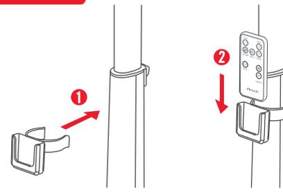
리모컨 수납함을 그림 ①의 방향으로 지주부에 끼운 후 그림 ②의 방향으로 리모컨을 수납함에 꽂아 보관하십시오. 수납함을 뺄 때에는 역순으로 해주십시오.
