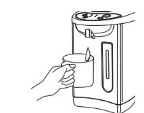
5. 설정한 보온온도 표시등의 깜빡임이 멎거나 가열/보온 표시등의 색상이 녹색으로 변경되면 급수구에 컵을 받친 후 잠금 해제버튼을 눌러 급수가 가능한 상태로 전환하여 주십시오.
